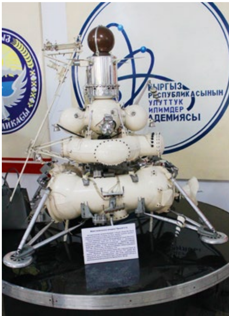
▲ Макет космического аппарата «Луна-24»
